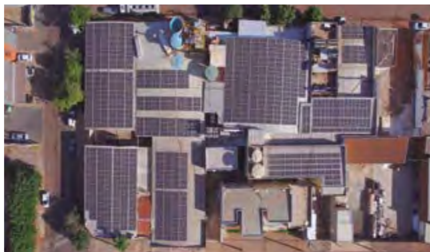
Placas fotovoltaicas instaladas: economizam cerca de 50 mil quilowatts por mês
